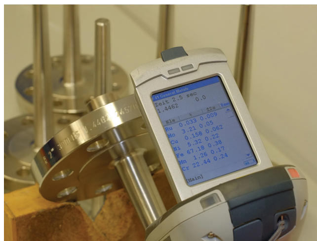
PMI-тест: Рентгеновский флуоресцентный анализ штока защитной гильзы
