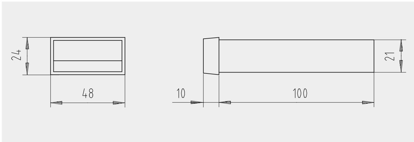
**Отверстие для монтажа в мм**
